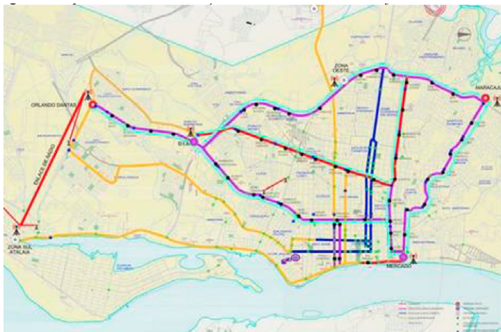
Figura 6: Mapa da rede de comunicação de dados do BRT de Aracaju
