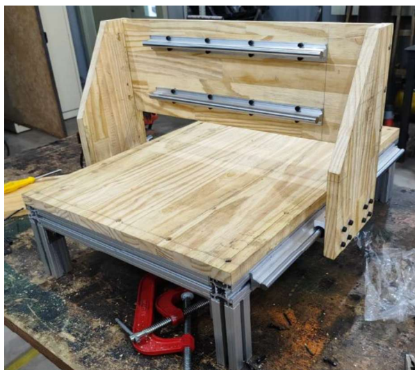
Figura 4 – montagem da estrutura e guias lineares
