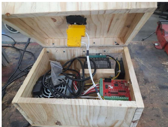
Figura 6 – caixa com componentes elétricos: fonte, drivers e placa controladora
