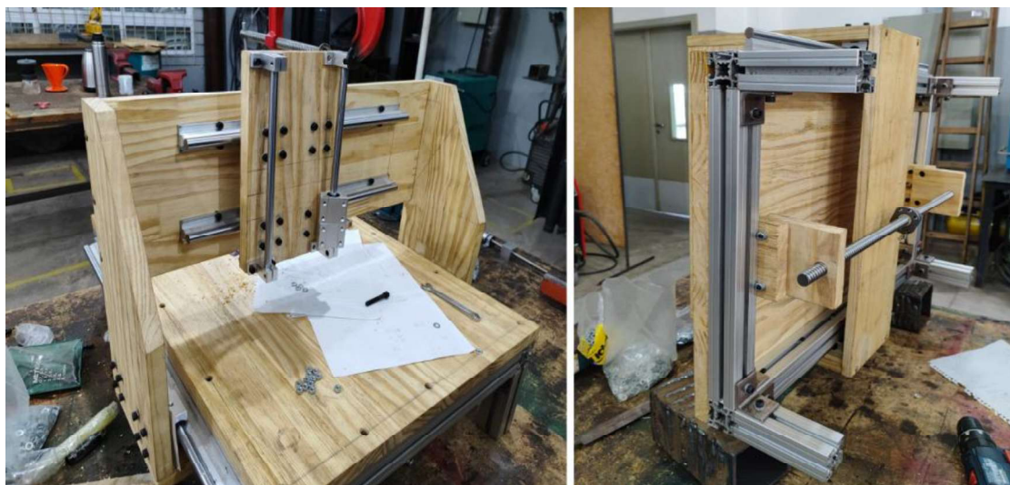
Figura 5 – (a) guias lineares do eixo z; (b) fuso de movimentação do eixo y
