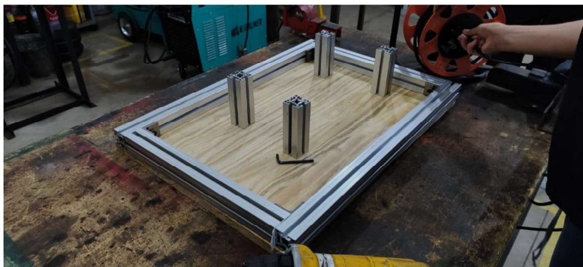
Figura 2 – base estrutural de alumínio (perfil retangular)
