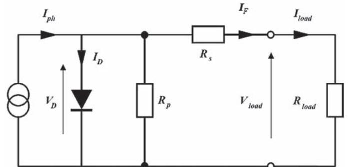
Figura 2 - Circuito equivalente da célula fotovoltaica
