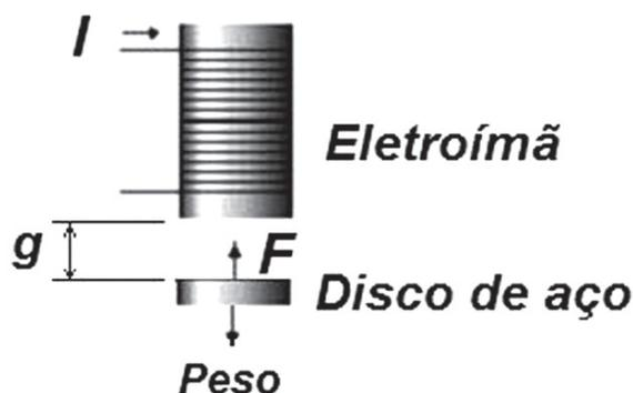
Para manter o entreferro constante, o projeto de um sistema de controle de posicionamento requer a linearização da função força em torno do ponto de operação  $I_o = 1$  A e  $g_o = 10^{-3}$  m. Após esse procedimento, uma nova função força pode ser definida:
