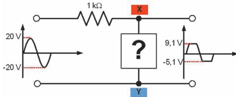
Em face do exposto, admitindo-se que todos os diodos são ideais, o circuito com diodo Zener entre os pontos X e Y (no espaço marcado com o ponto de interrogação) que deve ser inserido nessa posição é
