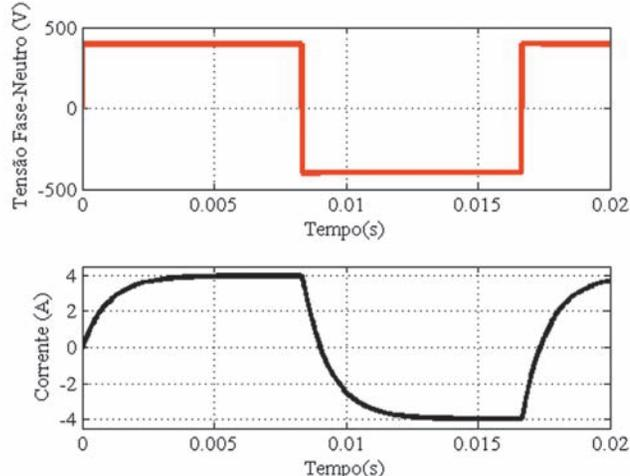
Considerando essas formas de onda, é correto afirmar que os verdadeiros sinais de tensão e corrente, característicos do acionamento dos motores de indução trifásicos pelos conversores de 6 pulsos e PWM senoidal, são apenas aqueles apresentados nas figuras
