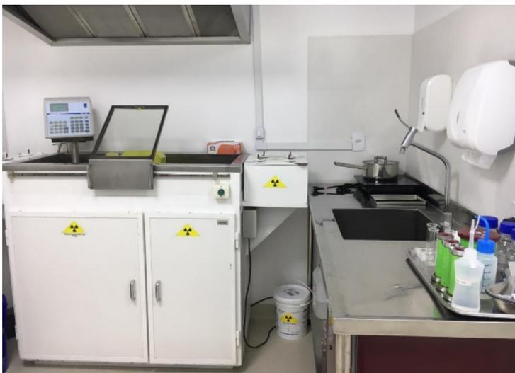
Figura 4 - Bancadas da radiofarmácia e sistema de exatuação de ar
