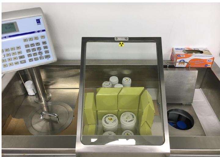
Figura 5 - Bancada de manipulação de radiofármacos
